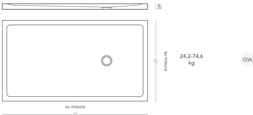
**Piatto doccia modello Unico semicircolare in Corian®, bacino termoformato. Foro pileta Ø 90 mm. Possibile montaggio filo pavimento. A richiesta fornitura pileta di scarico e/o fresatura per vetro. Larghezza e profondità del piatto doccia e posizione foro pileta sono personalizzabili (distanza minima dal bordo 250 mm).**
